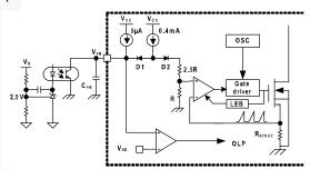
Figure 16. Pulse-Width-Modulation Circuit
